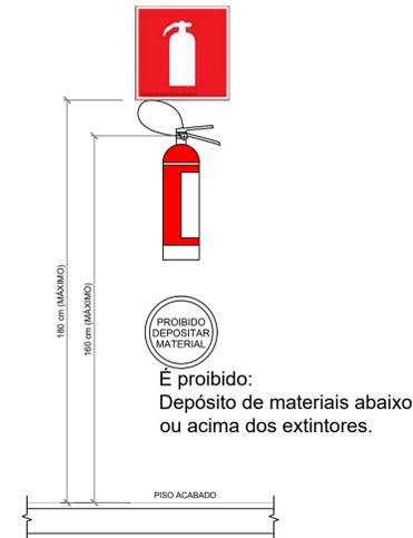
DETALHES DO EXTINTOR DE INCÊNDIO COM SINALIZAÇÃO PAREDE s/ esc
