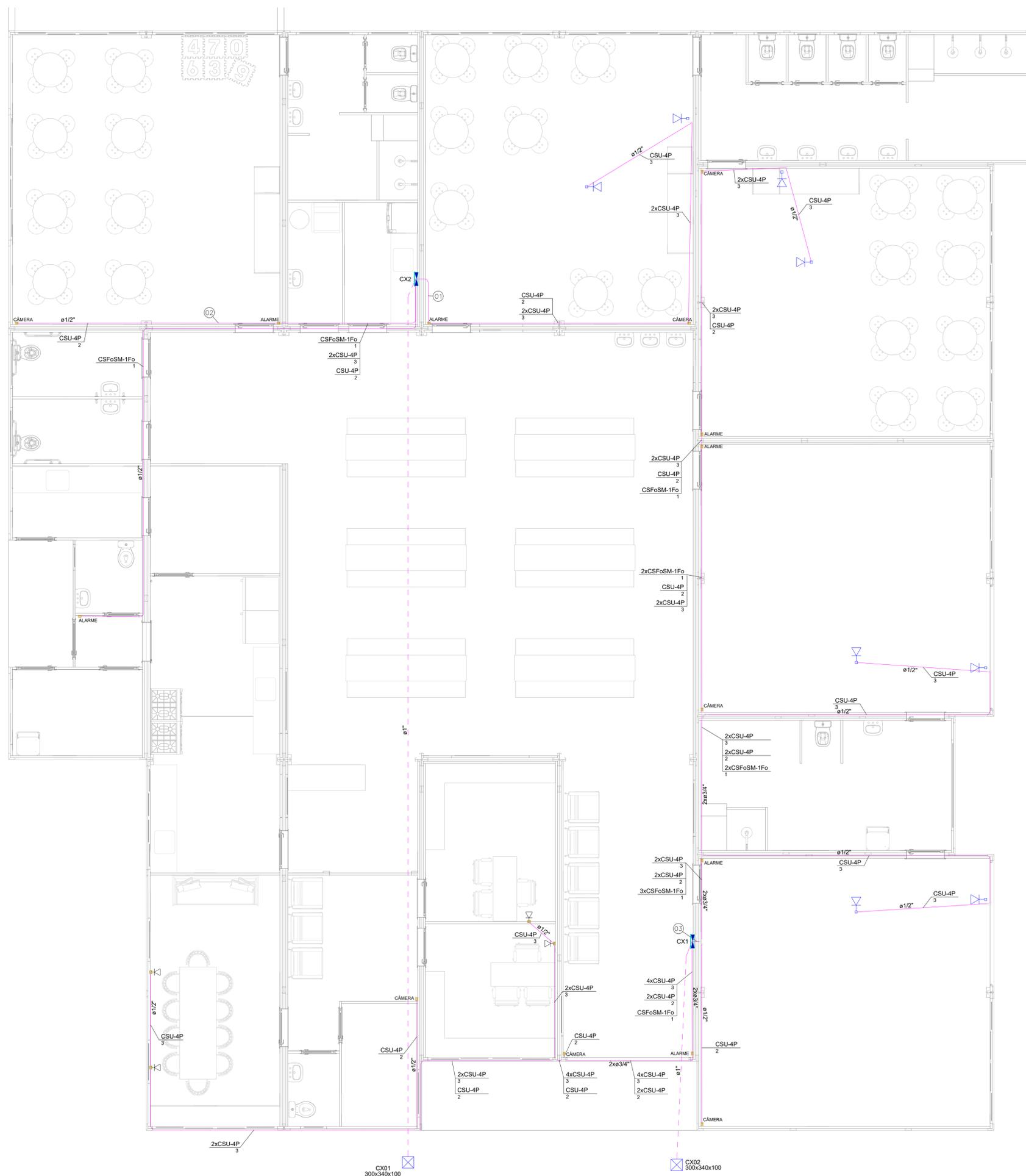
PLANTA BAIXA DO PAVIMENTO TÉRREO - PROJETO DE CABEAMENTO
