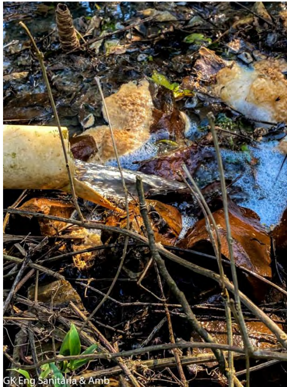
Figura 53 - Ponto de emissão do efluente tratado em solo. Notar a cor e a transparência da água, dentro dos padrões preconizados. Fonte: GK ENGENHARIA, levantamento de campo.
