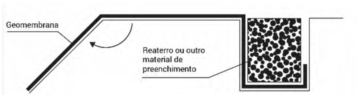
Figura 94 - Ancoragem da geomembrana. Fonte: GK ENGENHARIA, 2022.
