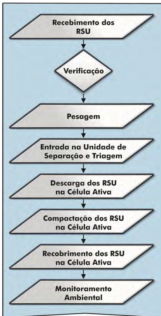
Figura 117 - Fluxograma operacional do processo desde a recepção até a compactação dos resíduos dispostos na célula ativa. Fonte: GK ENGENHARIA, 2022.
