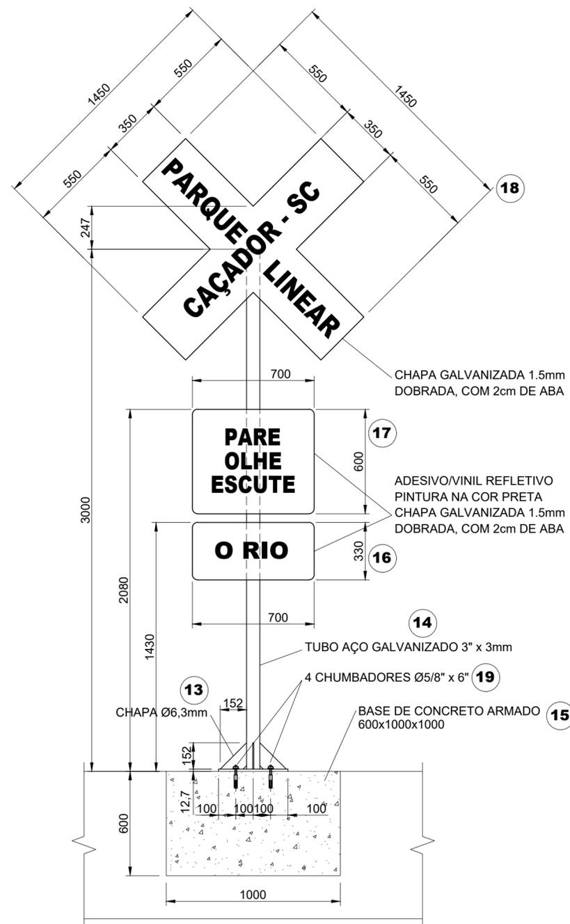
CHAPA GALVANIZADA 1.5mm DOBRADA, COM 2cm DE ABA
