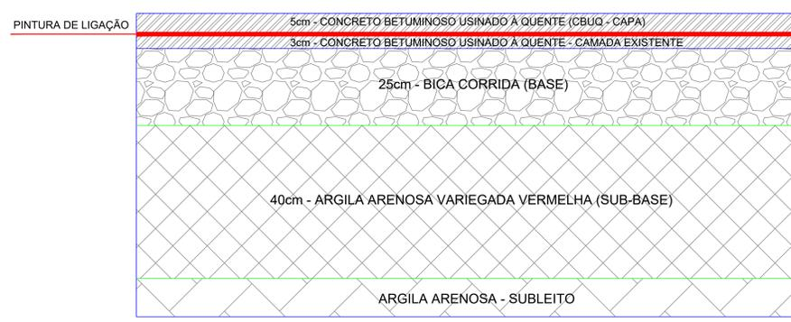
PDD 02/20 - DETALHE 02 - ESTRUTURA DOS PAVIMENTOS - SEÇÃO TIPO 2
