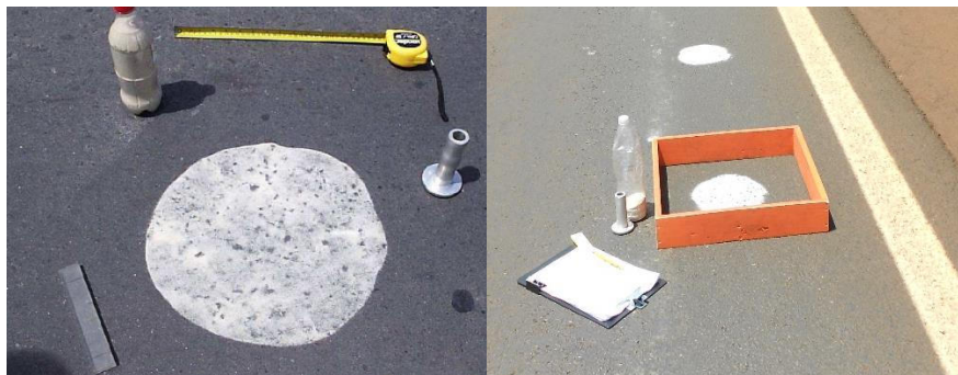
Ensaio de Mancha de Areia
