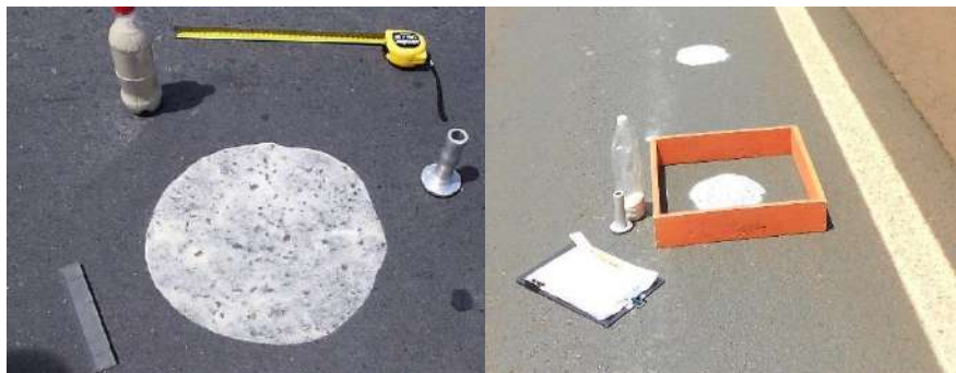
Ensaio de Mancha de Areia
