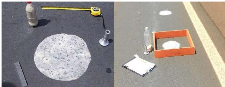
Ensaio de Mancha de Areia
