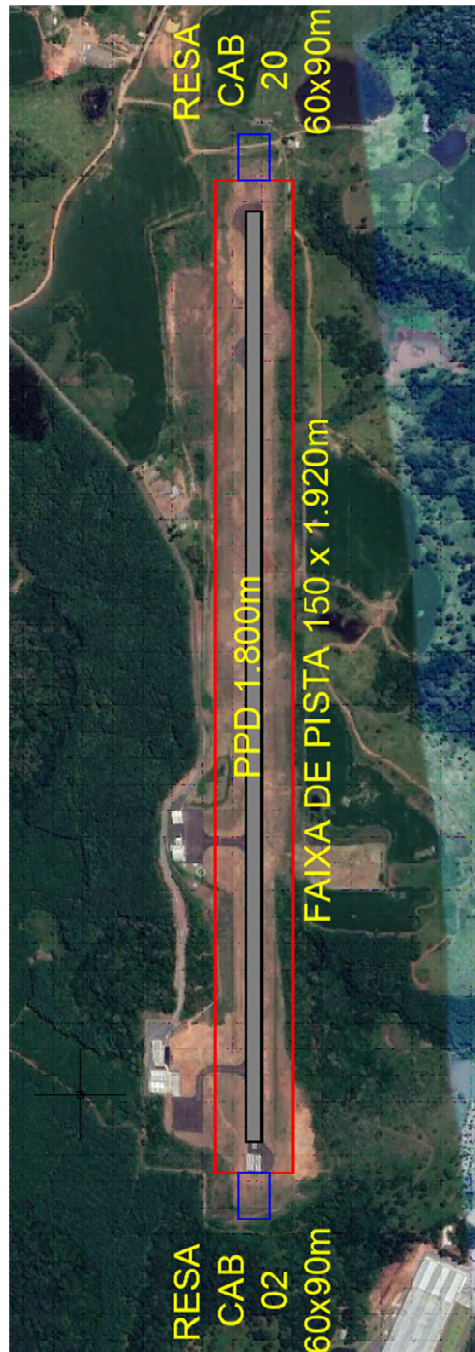
Figura 0-2 – Situação final da Faixa de Pista e RESA do Aeroporto de Caçador/SC.
