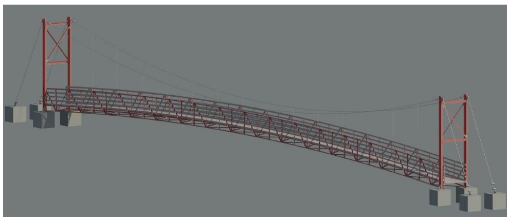
Figura 3: Definição geométrica da estrutura da Passarela
