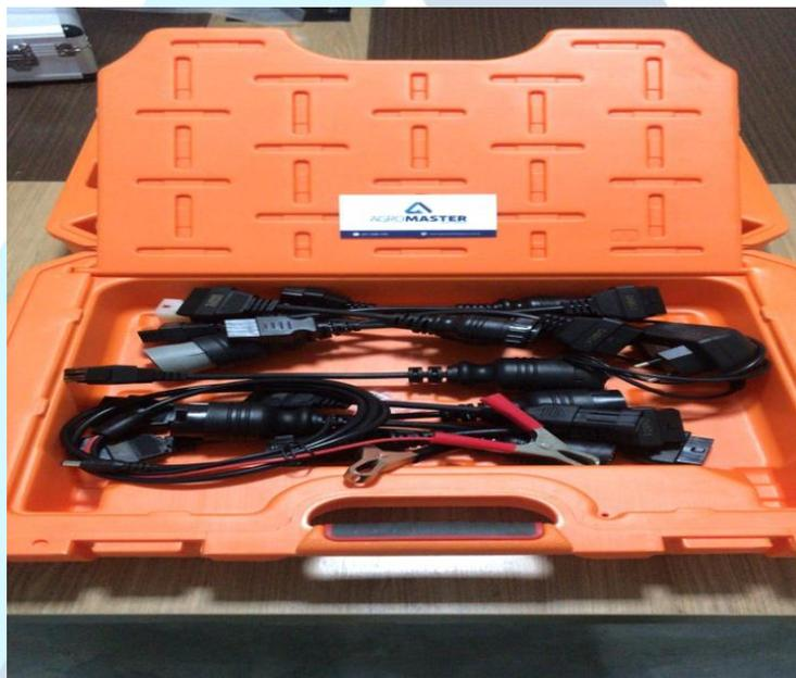
14: Aparelho Scanner mog. Rasther III ou similar ( Leitura Sistema. Injeção Eletr. Diesel)
