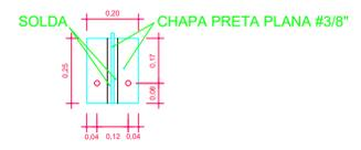
**SEÇÃO TRANSVERSAL (ESTRUTURA METÁLICA)**
