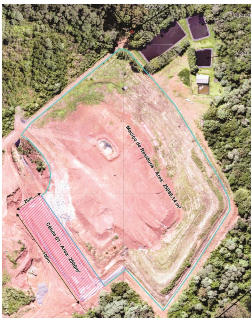
Figura 8 - Detalhe da localização da célula 01 em relação ao maciço de resíduos já existente.
