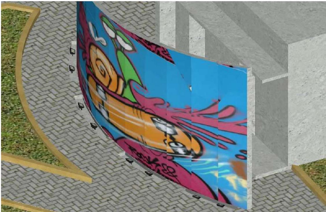
*Fig. 9 – Detalhe da distribuição dos refletores da iluminação do mural*
