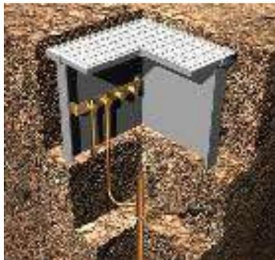
Fig. 12 – Detalhe da instalação da haste de aterramento
