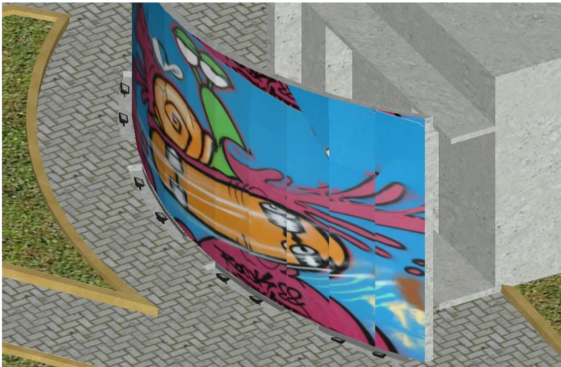
Fig. 9 – Detalhe da distribuição dos refletores da iluminação do mural
