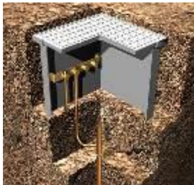
Fig. 12 – Detalhe da instalação da haste de aterramento
