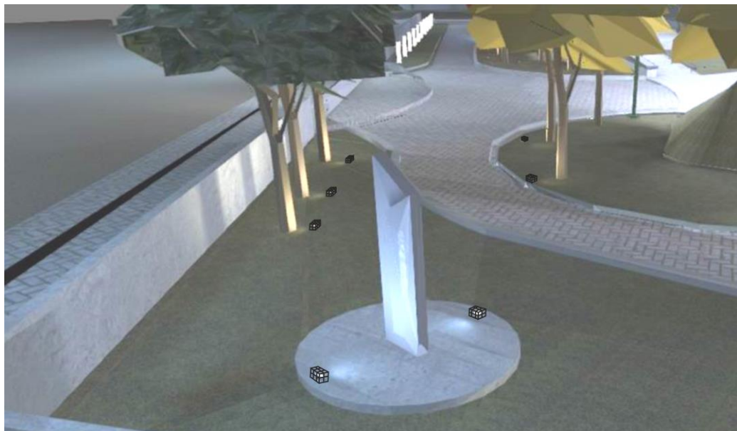
Fig. 10 – Instalação dos refletores no totem
